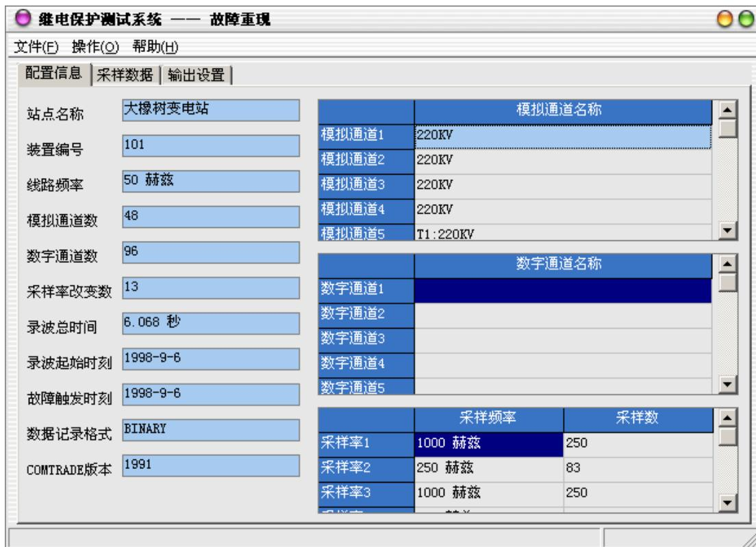
单击主菜单上的“文件”→“读取COMTRADE文件”或直接按下快捷键F6将打开文件输入对话框，在对话框中选择 COMTRADE 文件所在的目录，找到所在目录后程序会自动将所有后缀为 .CFG 的文件名列出来。选定某一文件后程序自动将该名字的 .CFG 和 .DAT 文件调入，并将 .CFG 文件中的信息显示在“配置信息”属性页中，如变电站名、录波装置编号等；将 .DAT 文件中的数据显示在“采样数据”属性页中。
