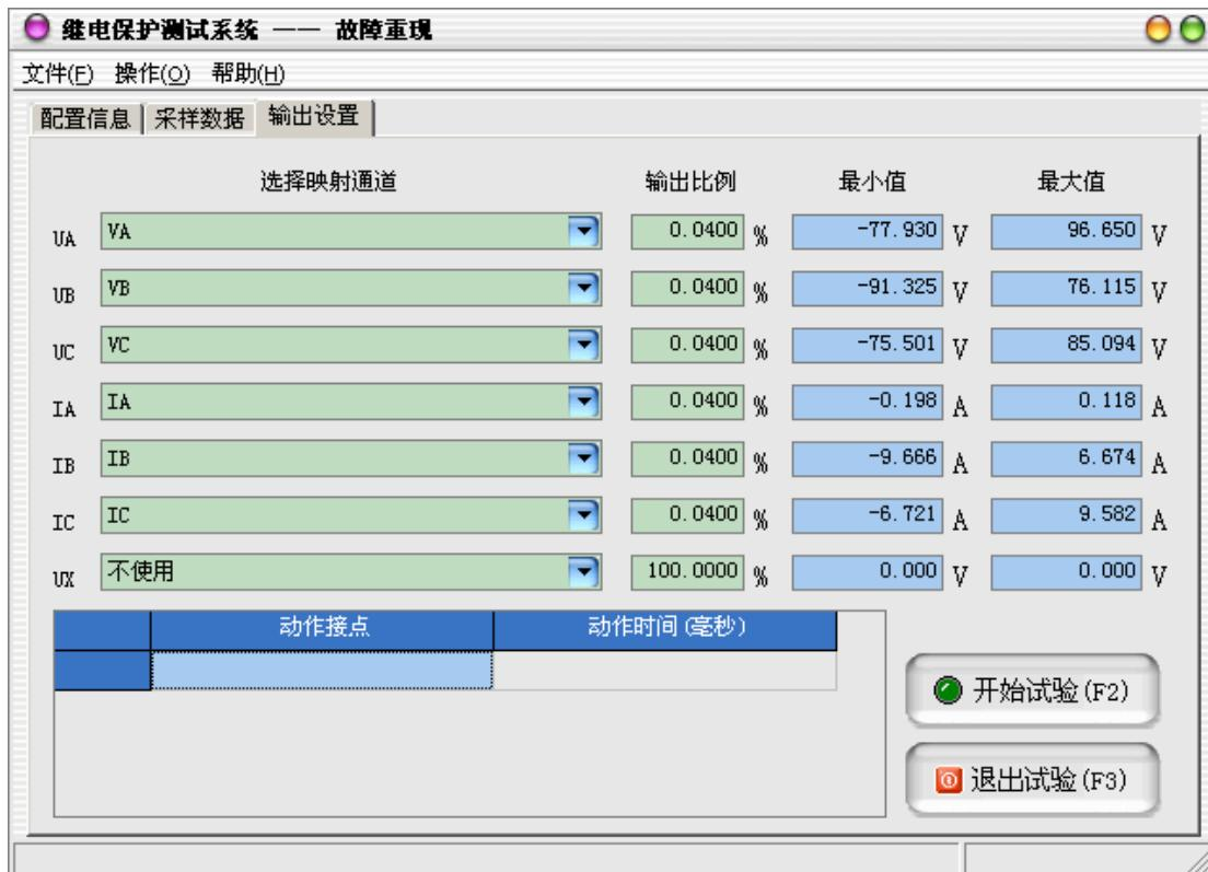
如果录波数据文件中记录的电压电流值为一次回路数据，则需要输入 PT、CT 变比，程序自动计算出各通道的二次回路数据并将其通过测试仪输出。在“输出设置”属性页中对需要输出的通道进行设置，用户可以在“选择映射通道”中将七个通道分别映射至读取文件中的电压或电流通道。在“输出比例”中可调整各通道输出幅值和原始数据的比例关系。
