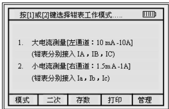
注：按数字 1 或 2 键选择钳表工作模式，进入相应的测量状态，钳表也接入相应的电流通道，一般首次测量都应接入 IA, IB, IC 通道，当实测电流信号小于 10mA 时为提高相位测量误差，再将钳表接入 Ia, Ib, Ic 通道测量，选择通道 2。进入测量界面后可按数字 1 复位重新进入通道选择。
