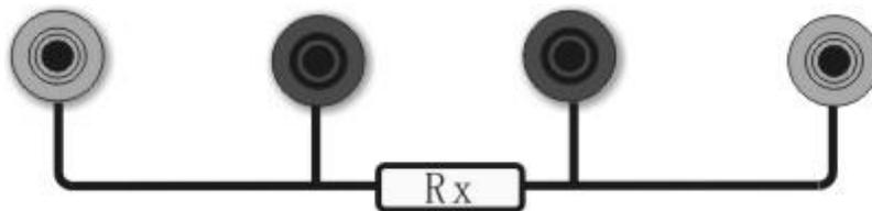
如上图所示，输出部分包括四个接线柱。其中外侧的两只接线柱为恒流源输出，测试电流既通过它送到待测的电阻。内侧的两只接线柱是测试电压的输入，本机即通过它来读取待测电阻上的电压值显示和键盘控制部分。
