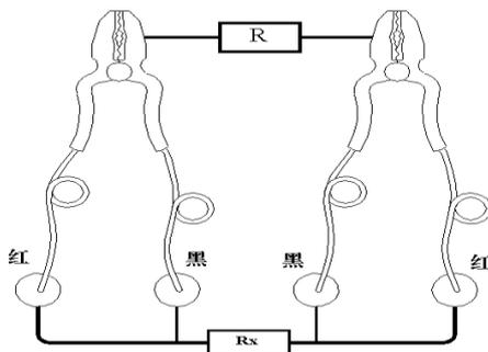
注意所选测试电流的测量范围要大于实际电阻值。按“测量”键后即开始测试。屏幕提示“正在测量请稍候”，屏幕中间的显示区显示测量的电阻值。待读数稳定后读取数值，然后可以根据需要按“存储”键存储测量数据或按“打印”键打印数据。
