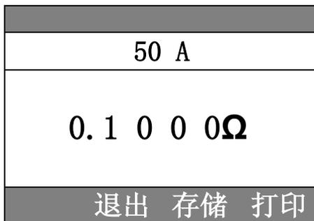
测量同一变压器同一电压等级的各相绕组时，应选择相同的电流进行测量，避免造成系统误差。变压器容量越大，绕组的电阻越小，选择的测试电流越大。注意所选测试电流的测量范围要大于实际电阻值。按“测量”键后即开始测试。这时屏幕出现“正在充电。。。”，并且有一个充电进度条以显示充电进程，**注意：如果充电进度条长时间静止不动，则是被测负载过大（超量程），请换小电流档位。**充电结束后屏幕提示“正在测量请稍候”，屏幕中间的显示区显示测量的电阻值。待读数稳定后读取数值，然后可以根据需要按“存储”键存储测量数据或按“打印”键打印数据。
