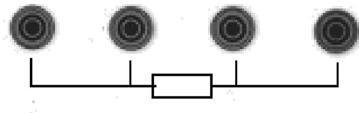
如上图所示，输出部分包括四个接线柱。其中外侧的两只接线柱为恒流源输出，测试电流既通过它送到待测的电阻或变压器。内侧的两只接线柱是测试电压的输入，本机即通过它来读取待测电阻上的电压值显示和键盘控制部分。
