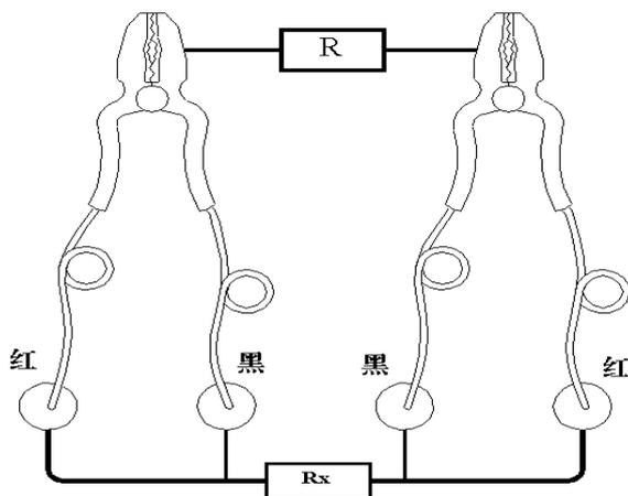
当确认待测电阻和仪器可靠的连接好后，按屏幕显示的“▼” “▲”对应按键切换测试电流。
