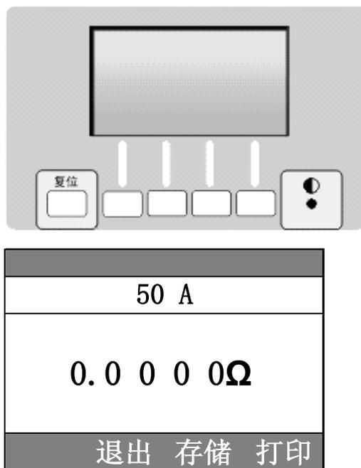
本机的显示器是一个 128×64 点阵液晶显示器，电阻的测量值以及操作信息均通过它显示。显示器分为三个区：上层显示当前测试电流；中间的显示区显示测量的电阻值；最下显示仪器按键功能提示。（因工作状态不同，显示的汉字不同，按键的功能也不同，有关它们的详细信息请参阅后面相关部分）。
