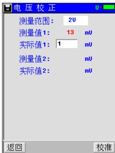
每个通道进行两个测量点的校准，如上图 2-13 所示。校正前有一个问题必须清楚：每个电压档位都有一个最大的测量值，比如说 12V 档位的最大测量值是 1600mV，当校正此档位时就绝对不能超过这个值。校正方法：一般先从大电压的档位校正，例如校正 12V 档位，选用 1450mV 和 980mV 这两个点来校正；把 3915 接到一个可调直流电源上，调节直流电源到 1450mV 左右，用万用表测出这个实际电压，然后输入到实际值 1 中，点击“校准”按钮就完成第一个点校准，并自动跳到下一个点的校准框中，接着再调节直流电源到 980mV 左右，用万用表测出此值，并输入到实际值 2 中，点击“校准”按钮就完成了 12V 档位的电压校准，按同样的方法即可完成其他档位的校准，完成后进入“保存参数”菜单中保存参数，电压校正完成。
