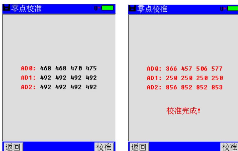
点击“校准”按钮，界面显示“正在校准...”即进入零点校准环节，校准完成后显示“校准完成!”，如图 2-11 所示，此时已进行一次零点校准。点击“校准”按钮将会进行新的一次校准过程。
