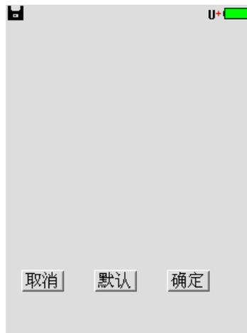
点击触摸屏四周边缘区域，尽量得到触摸屏最接近边界的 AD 值(屏上会显示触摸点的 AD 值)，单击“确定”按钮会保存校准结果。“默认”按钮则载入仪表默认的触摸屏校准系数，点击“取消”按钮取消本次校准。
