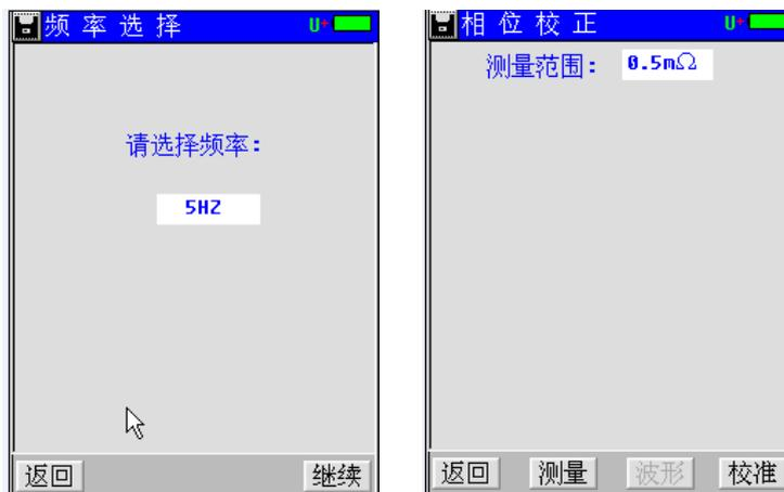
首先选择频率，点击“继续”按钮即进入相位校准界面。在各个档位夹上相应的标准电阻进行测量，比如校准“0.5mΩ”档，夹上 0.5mΩ 的标准电阻点击“测量”，然后点击“校准”按钮即完成 0.5mΩ 档的相位校准，并自动跳入下一档位，按同样的方法即可完成其它档位的校准。完成后进入到“保存参数”菜单中保存参数，相位校正完成。
