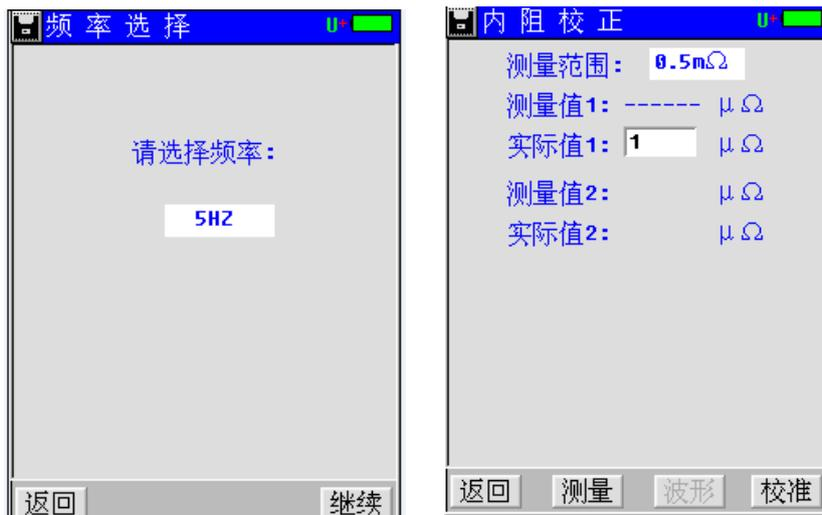
校准方法：内阻校准跟电压校准类似，每个档位校两个我公司提供的标准电阻（也叫分流器）。正确连接好内阻校准线，如校准 0.5mΩ 档，选用 0.25mΩ 和 0.5mΩ 来校准，夹上 0.25mΩ 的标准电阻，点击“测量”，测量完后在实际值 1 中输入“250”，然后点击校准完成第一个电阻的校准；接着再测量 0.5mΩ 的电阻，完成后点击“校准”就可完成 0.5mΩ 档的校正。按同样的方法即可完成其他档位的校准。校准 1.0mΩ 档，选用 0.5mΩ 和 1.0mΩ 来校准，校准 3.7mΩ 档，选用 1.0mΩ 和 3.75mΩ 来校准，校准 15mΩ 档，选用 3.75mΩ 和 15mΩ 来校准。校准完所有档位后，进入到“保存参数”菜单中保存参数，内阻校正完成。
