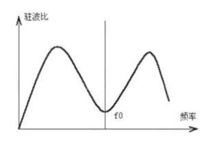
图中 f0 为第一驻波点的频率,在"分析"功能状态下通过"左移"键或"右移"键移动标识线,反复在第一驻波点附近调整,观察显示屏下方 A 的值(驻波比)变化,找出最低点。此时显示出的距离 L 为故障距离, f 为第一驻波点的频率, A 为驻波比。
