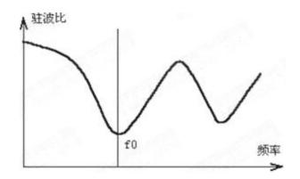
线路短路故障时驻波比与频率的关系见下图:
